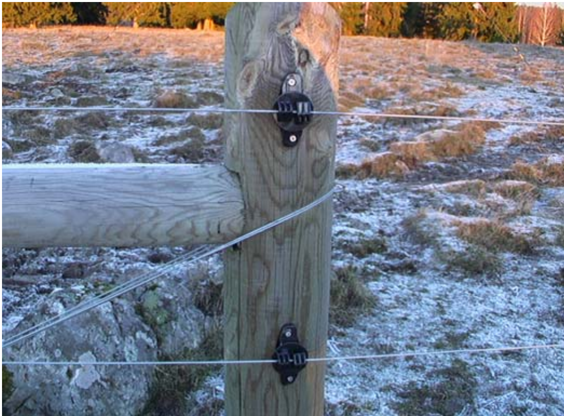
Bild 2. Hållbara isolatorer skruvas med gipsskruv.
