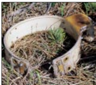
Das Halsband mit dem Radiosender verfügt über eine Sollbruchstelle, die nach ca. 2 Jahren durchbricht.
